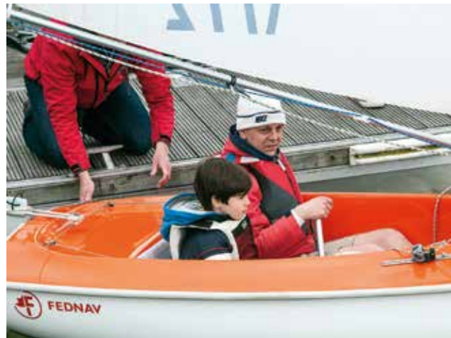
Het roer van de boot is vervangen door een stuurknuppel
